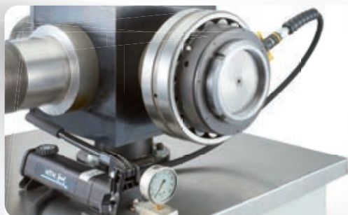
Estrazione della bussola di serraggio tramite la ghiera idraulica
